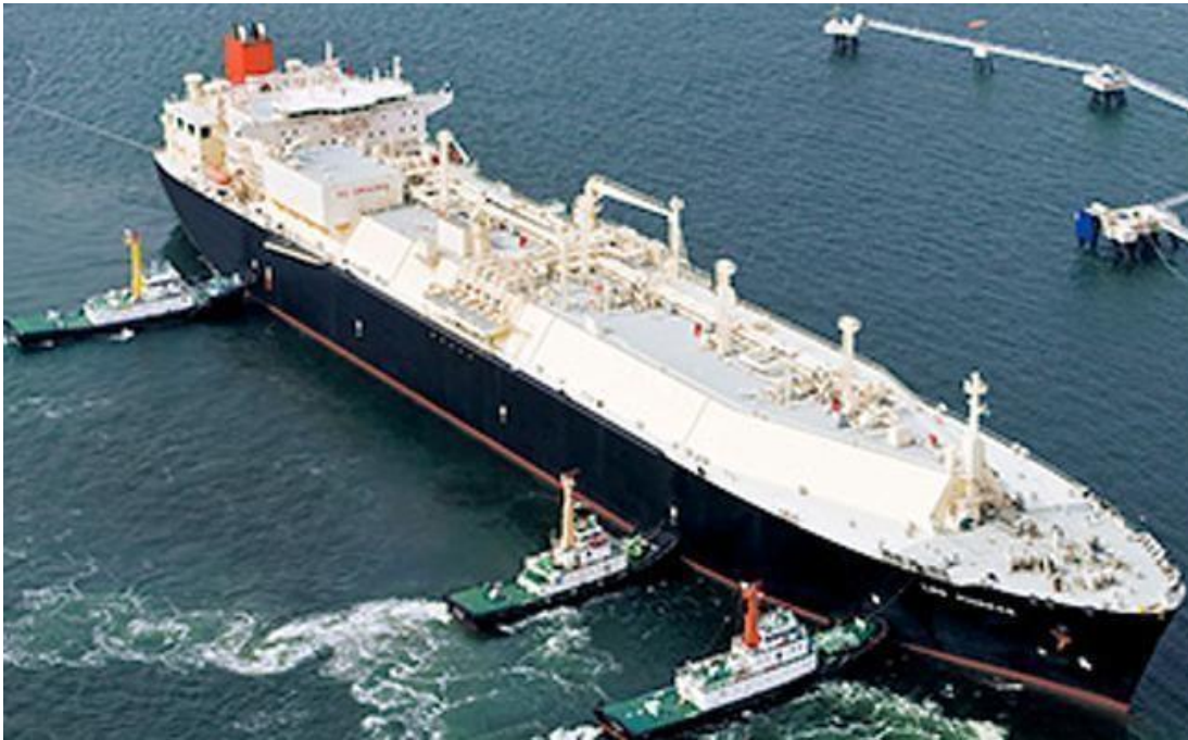
Transporteur GNL typique de 216 000 m 3 avec des réservoirs de confinement à membrane
