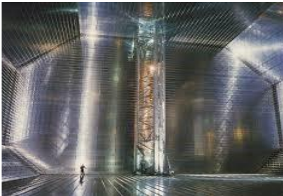
À l'intérieur du réservoir à membrane d'un transporteur de GNL typique de 266 000 m 3
