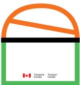
La deuxième forme est un demi-cercle bordé d'une bande de couleur orange international au-dessus d'une ligne noire surmontant un demi-rectangle bordé d'une bande de couleur verte. Le demi-cercle doit contenir un symbole de restriction se retrouvant dans le tableau 1 ci-dessus, et le rectangle doit décrire les conditions se retrouvant dans le tableau 2 ci-dessous.
