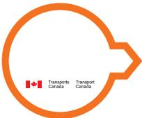
La première forme est un disque de direction, avec une flèche qui pointe dans la direction où s'applique la restriction. Le disque de direction doit contenir le symbole décrivant la restriction. Veuillez consulter le tableau 1 ci-dessus pour plus de détails sur les symboles.
