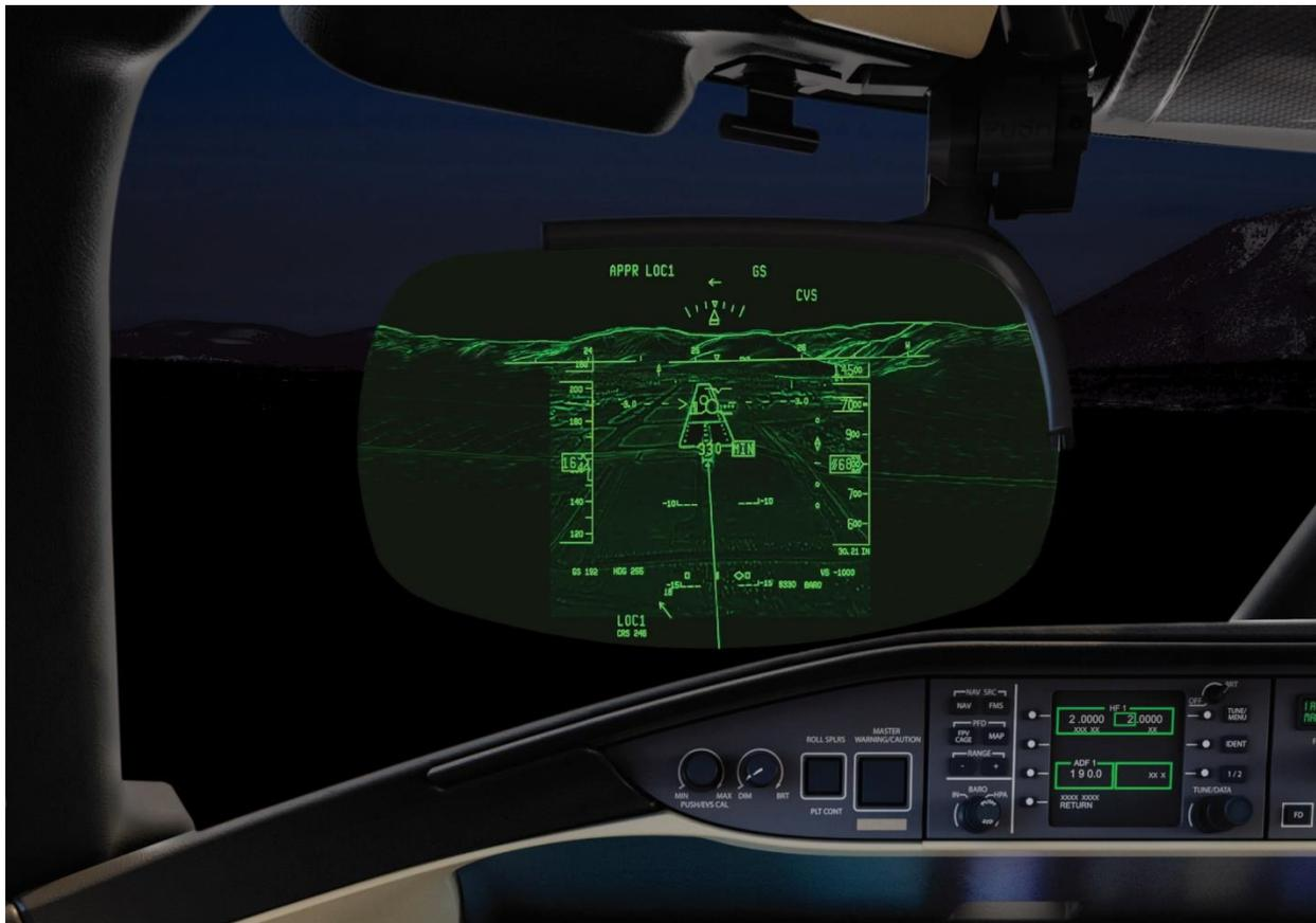
Figure 4 : Système HUD, comme ceux qui peuvent être utilisés pour les procédures d'approche ILS CAT I avec approbation spécifique (Crédit : Bombardier Inc.).
