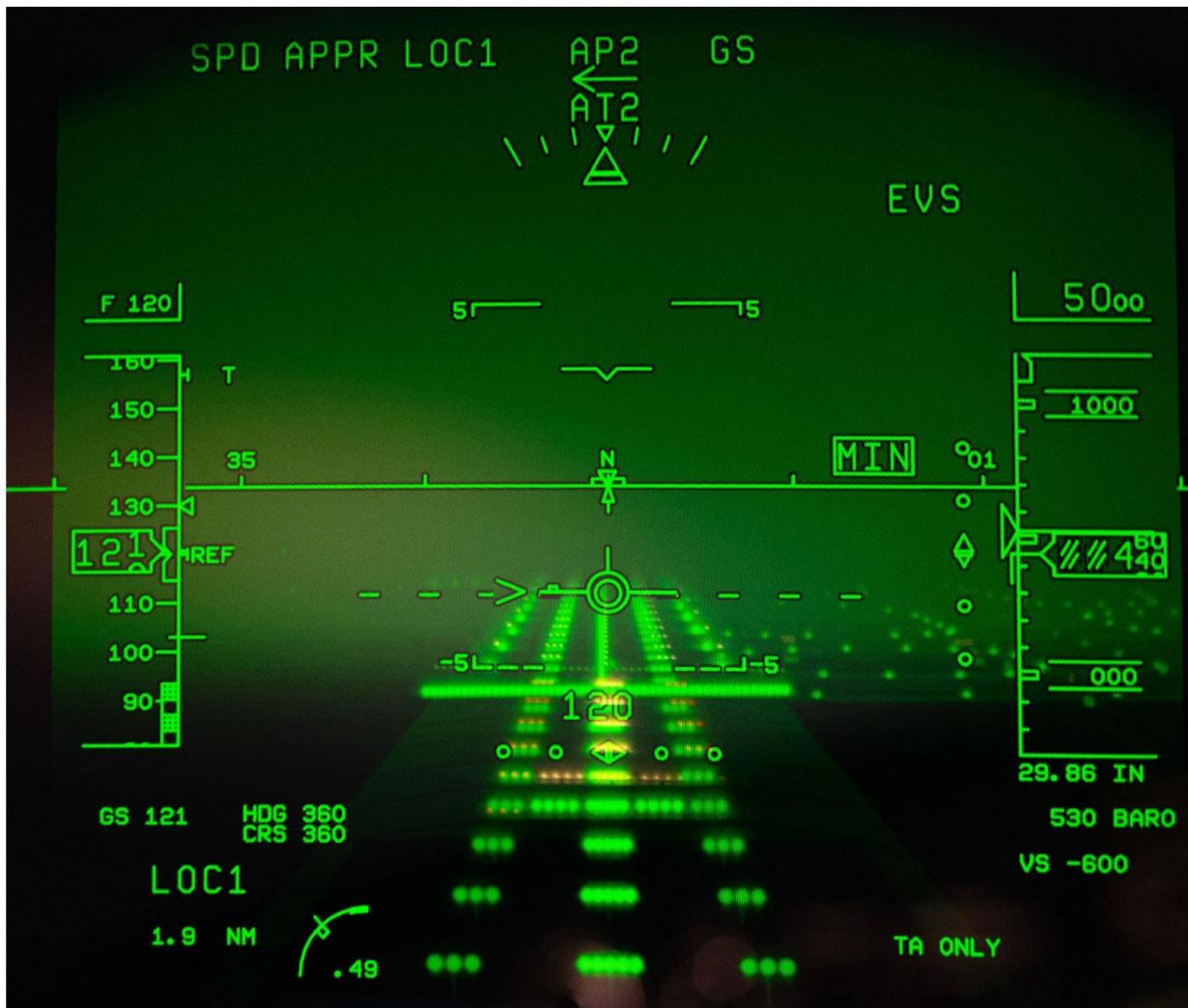
Figure 2 : Image produite par l'EFVS affichée sur le HUD d'un avion
