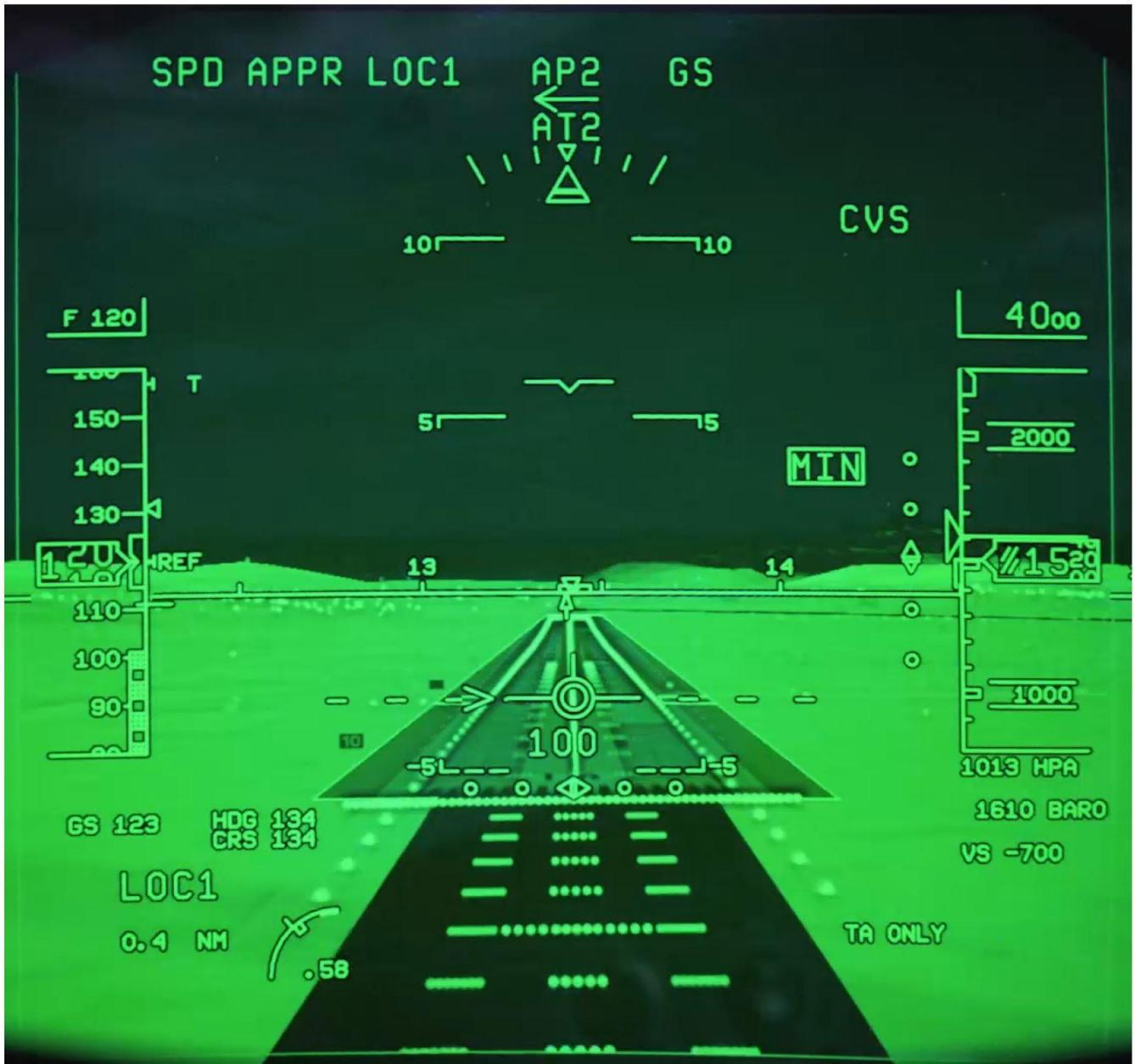
Figure 3 : Image produite par un système de vision combiné, incorporant des éléments EFVS et du système de vision synthétique (Crédit : CAE Inc. © CAE Inc. 2024).
