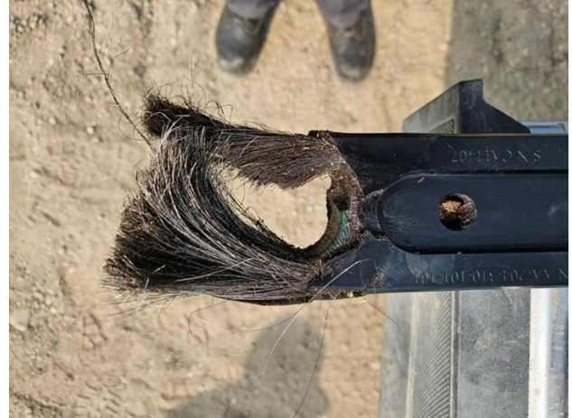
Figure 1 – Faisceau torsible défaillant d'Airwolf de l'accident du 28 juin 2024 (Source: BST 1 )
