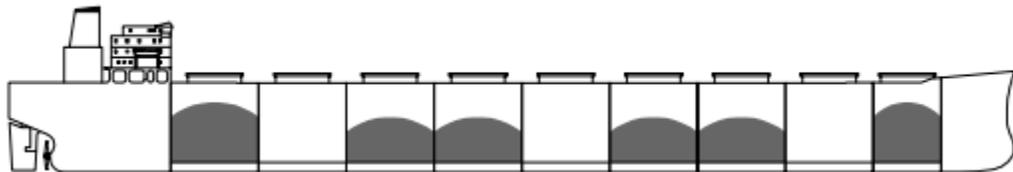
3. La cargaison en blocs de deux ou plusieurs cales contiguës, les cales adjacentes à ces blocs restant vides - chargement par **BLOCS** - est une configuration fréquente de chargement partiel.
