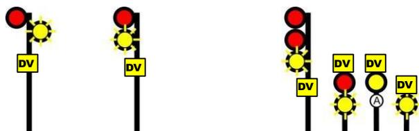
De vitesse de bifurcation à arrêt – Avancer, vitesse DE BIFURCATION au franchissement du signal et des branchements, être prêt à s'arrêter au signal suivant.
