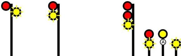
De petite vitesse à arrêt – Avancer, PETITE vitesse au franchissement du signal et des branchements, être prêt à s'arrêter au signal suivant.
