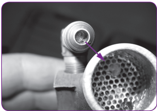
Figure 3 — Glace formée à partir de gouttelettes d'eau surfondue sur la crépine du dispositif de retour de carburant
