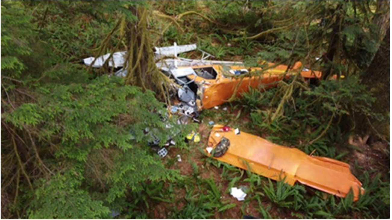
Figure 4 : Fuselage, flotteurs et aile gauche de l'aéronef (Source : BST)
