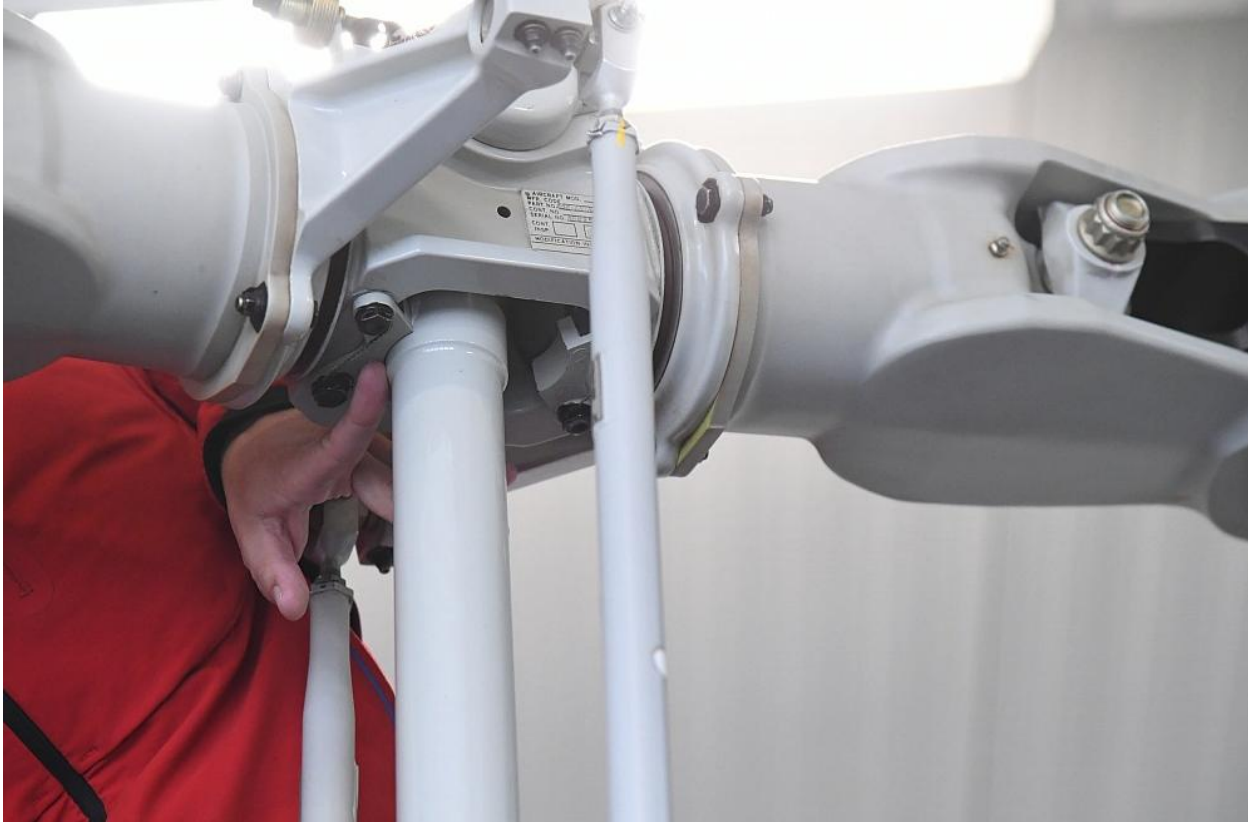
La figure 2 « tête B206 » est le dessous d'une tête de rotor Bell 206 normale. On pointe le niveau de la butée statique boulonnée et à côté de la zone d'interférence entre la butée et le mât
