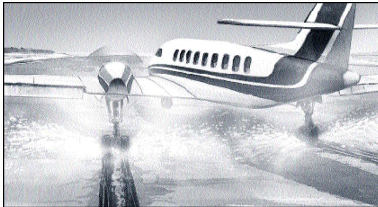
Juste un peu de neige fondante peut affecter le contrôle de l'aéronef.
