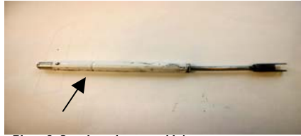
Photo 2: Steering tube assembly/ Photo 2: Ensemble du tube d'orientation
