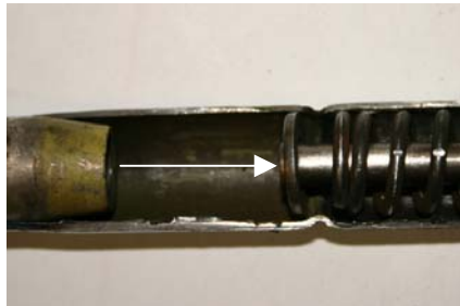
Photo 4 : Washer past the crimp as found Photo 4: Rondelle au-delà de la sertissage, là où trouvée
