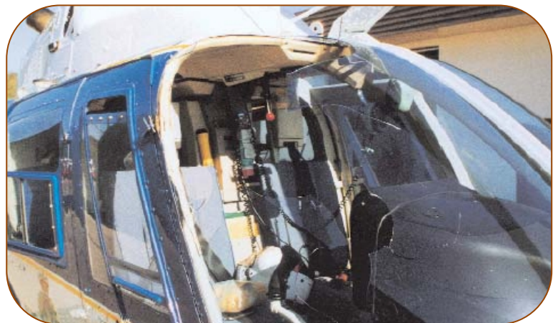
Un impact avec un grèbe élégant (3 lb) a causé des dommages considérables à cet hélicoptère. L'oiseau a heurté le visage du pilote.
