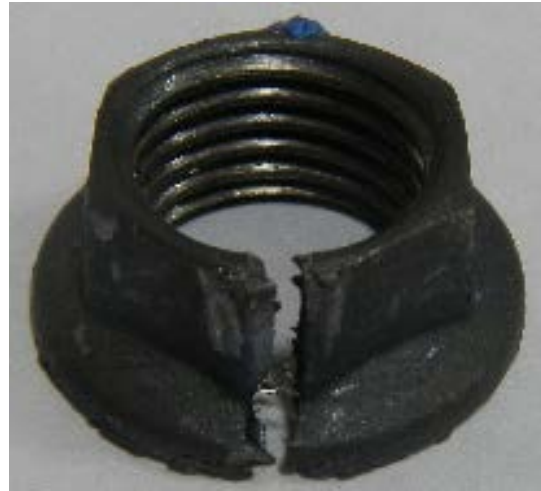
Figure 3; écrou NAS1291-7 fissuré trouvé par un exploitant d'hélicoptère.
