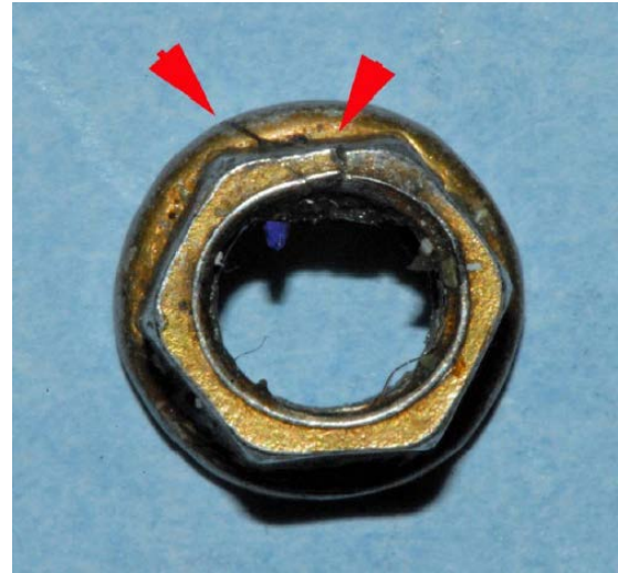
Figure 1; Constatation typique d'un écrou MS21042-4 fissuré à cause d'une fragilisation par hydrogène.
