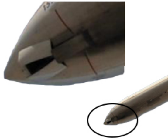
Figure 1: La photo d'un survol montre les trappes avant du train avant partiellement ouvertes.
