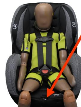
Figure 1. Emplacement du mécanisme de réglage avant central
