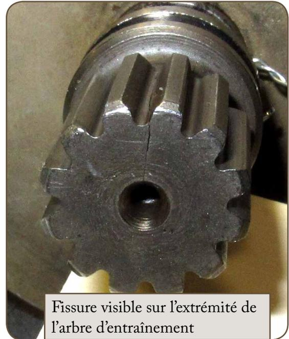
Fissure visible sur l'extrémité de l'arbre d'entraînement
