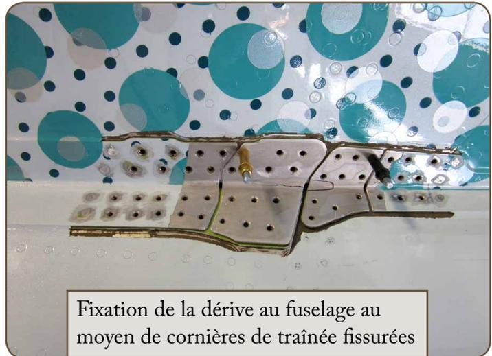
Fixation de la dérive au fuselage au moyen de cornières de traînée fissurées
