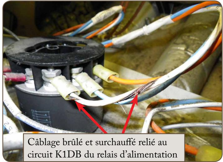
Câblage brûlé et surchauffé relié au circuit K1DB du relais d'alimentation
