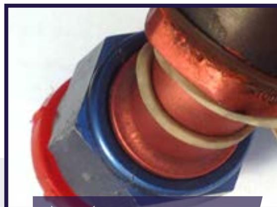
Raccord « Army-Navy » (AN) fissuré de la conduite carburant
