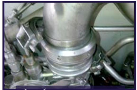
Bride de serrage défectueuse sous la pièce de retenue du boulon en T
