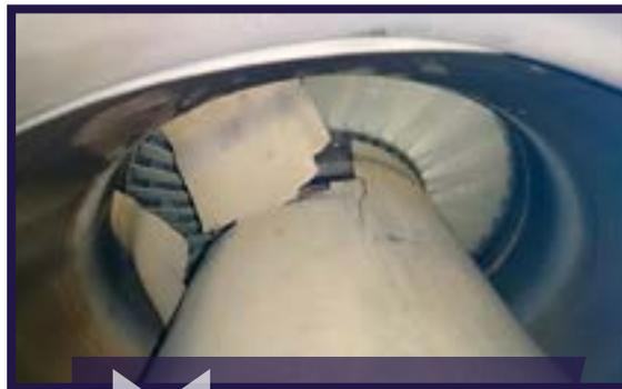
Conduit d'échappement endommagé causant du frottement sur le disque de la turbine
