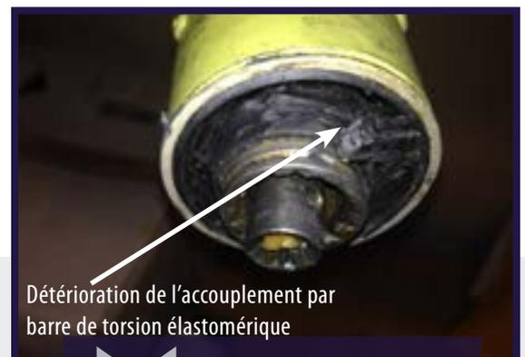
Détérioration de l'accouplement par barre de torsion élastomérique
