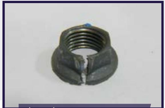
Écrou NAS 12917 fissuré
