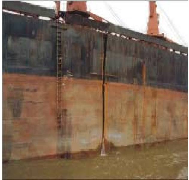
Fracture du côté bâbord
