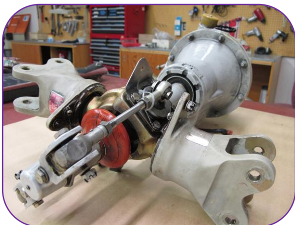
Photo 3 : Rotor de queue et vue du boulon brisé
