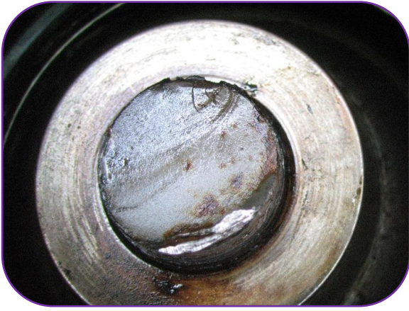
Photo 2 : Gros plan sur le boulon brisé
