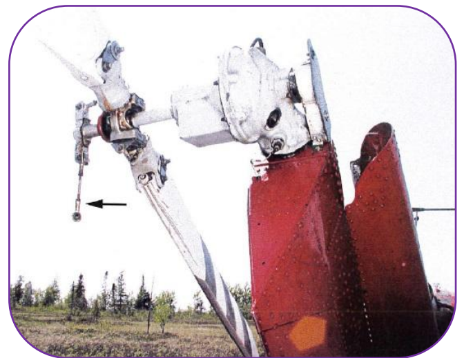
Photo 1 : Biellette de commande de pas détachée — incident de 2003
