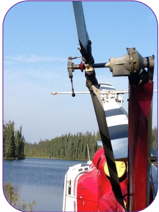
Photo 4 : Biellette de commande de pas détachée — incident de 2013
