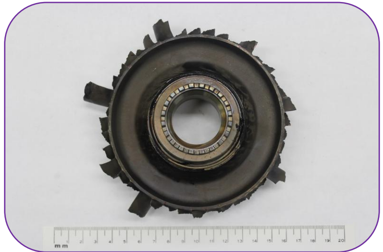
Disque de la turbine de troisième étage en cause
