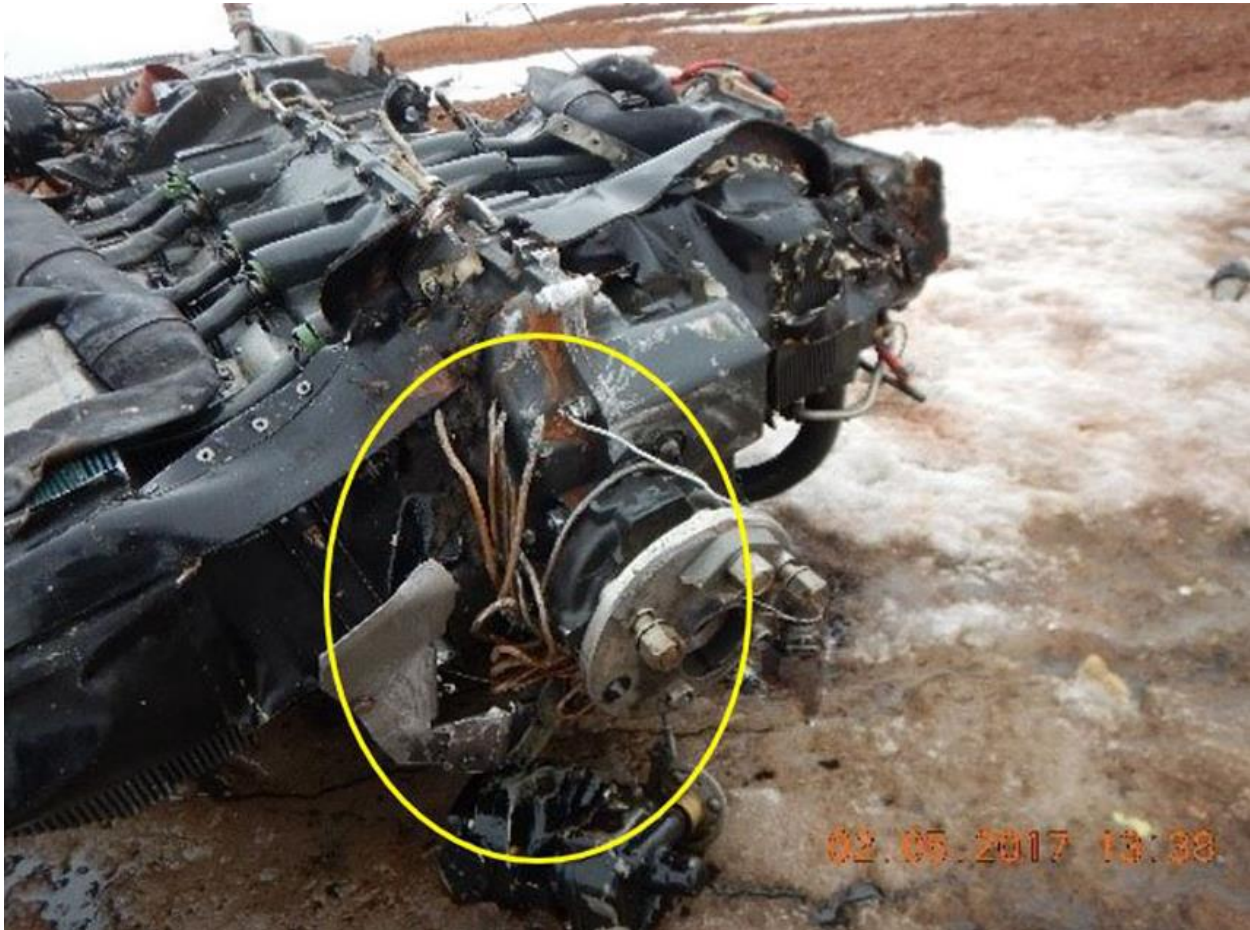
Figure 4. Moteur gauche : le cercle marque les sections de câbles enroulés autour de l'arbre moteur
