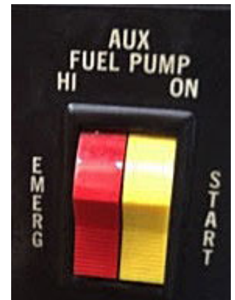
Figure 3 : Interrupteur de la pompe carburant auxiliaire
