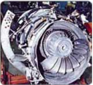
Truoréacteur détruit à la suite d’un impact avec des oiseaux. L’incident s’est produit au décollage, 50 pieds AGL, 140 nœuds.
