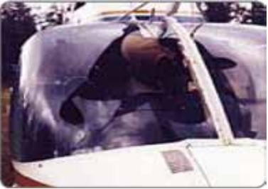
Habitacle à verrière bombée d’un J et Ranger fracassé par un oiseau.
