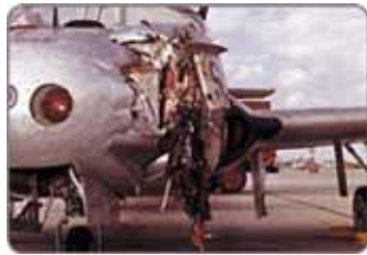
Dommages causés par l’impact d’un urubu à tête rouge.
