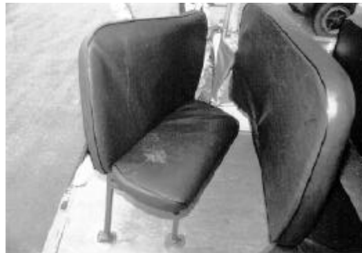
Déformation vers l'avant des sièges
