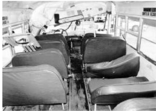
Déformation des dossiers des sièges
