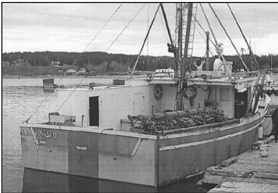
Figure 1.0 (d)(i) : Élargir un bâtiment de pêche en ajoutant une nouvelle rallonge centrale. (Source : Inconnue.)
