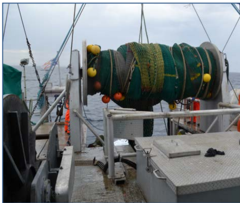
Figure 5.0 (a)(ii) : Tambour de type courant (et filet) utilisé à bord d'un chalutier côtier. (Source : collection personnelle de J.G.)
