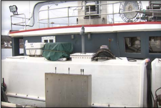
Figure 4.0 (g)(i) : Citerne antiroulis de type courant installée à bord d'un bâtiment de pêche. (Source : FVSS – CCPP)
