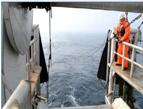
Figure 5.0 (a)(iii) : Lors de la pêche au chalut, des forces importantes sont exercées sur les enrouleurs. (Source : collection personnelle de J.G.)
