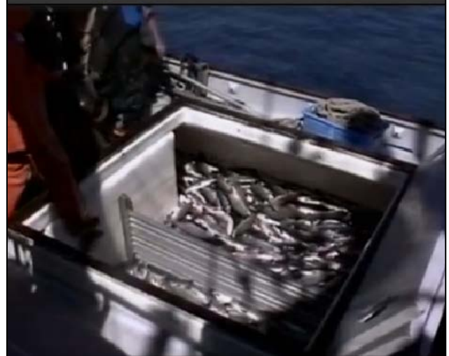
Figure 2.2. Réduire la largeur d'une citerne en ajoutant des cloisons atténue grandement la perte de stabilité. (Gracieuseté du CCPP)
