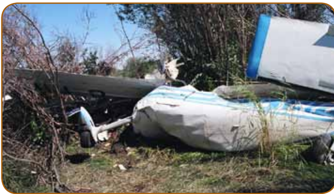
Cet accident survenu en 2006 fut la conséquence d'une erreur de pilotage entraînant un décrochage aérodynamique suivi d'une vrille.
