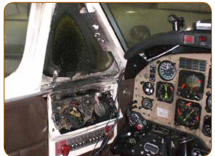
Domages causés par le feu dans un King Air 100.
