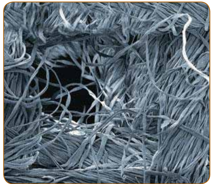
Un filtre humide signifie que le substrat est imbibé d'huile poisseuse qui retient les particules de poussière.
