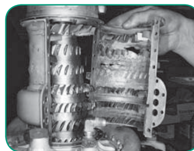
Coquille de carter compresseur enlevée pour exposer les dommages causés aux bords d'attaque et de fuite des aubes fixes et mobiles
