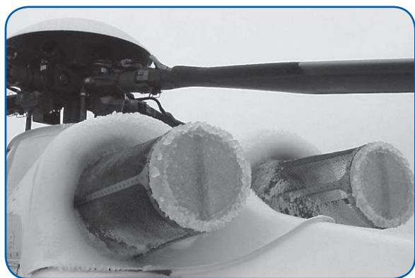
Prises d'air givrées, alors que les pales sont propres
