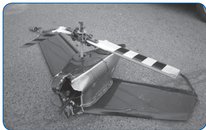
Cette photo illustre l'assemblage du rotor de queue au site de l'accident. Le rotor principal et le rotor de queue sont restés relativement intacts.
