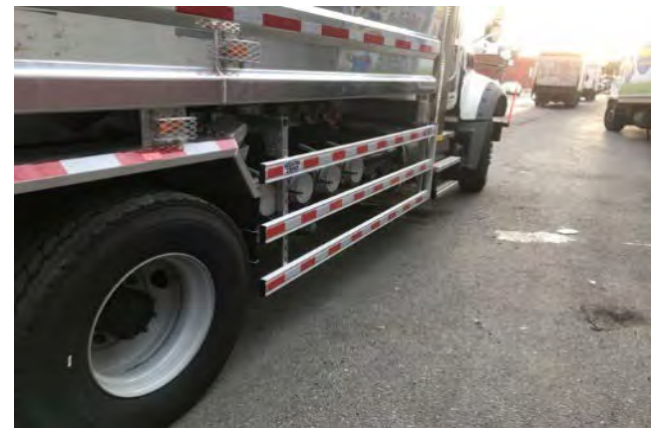
Installation de camions du service des incendies de New York TAKLER USA (protections latérales en rampe)
